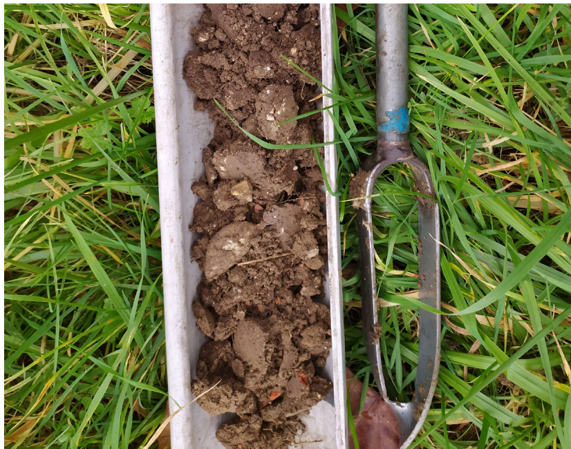
Figure 20 : Photo zoom du sondage S14 (remblais calcaires et morceaux de tuiles) (Crédit © : CERAG)
